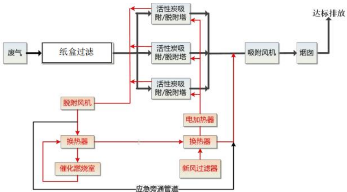
图 6 有机废气处理设施工艺流程图
